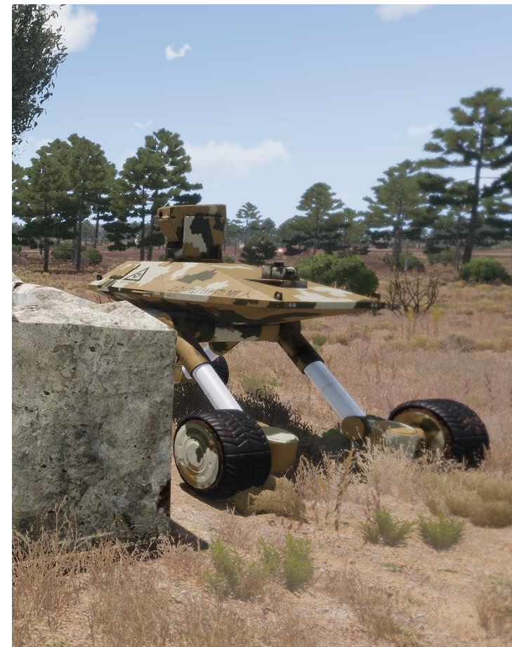
Manta UGV in posizione da imboscata dietro a un ostacolo con scafo sollevato
